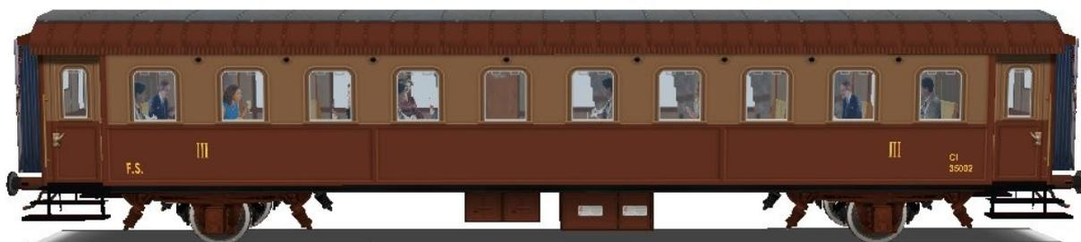
Le carrozze a 2 assi Tipo 1936 furono costruite per realizzare treni leggeri, detti accelerati, di limitata composizione e peso, con l'intento di permettere alle locomotive a vapore impiegate negli anni '30 maggiori accelerazioni dopo le fermate e, di conseguenza, aumentare la velocità media e ridurre i tempi di percorrenza di tali convogli.
