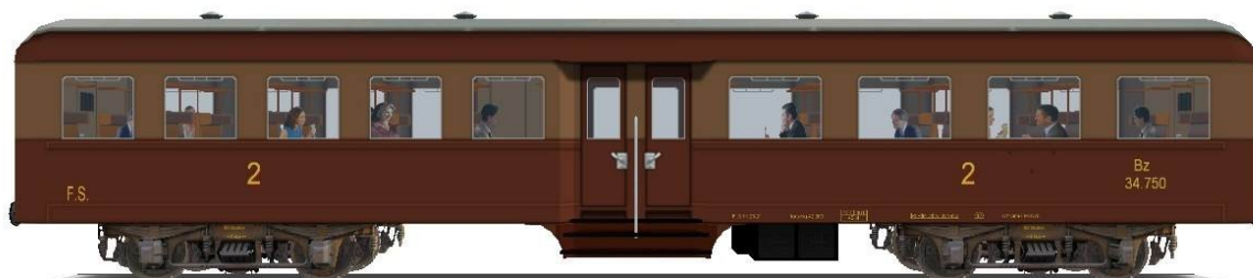
Illustrazione 9: Tipo 1947, Bz 34.750 (1958-70) ex miste e dotate di quattro aeratori sul tetto
