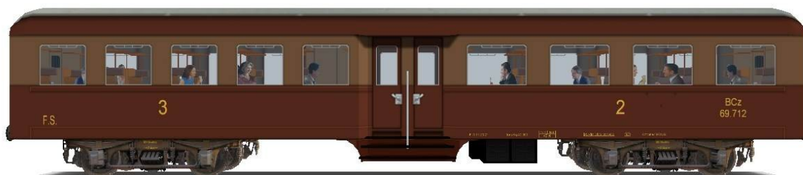
Illustrazione 3: Tipo 1947, BCz 69.712 (1954-56) vetture miste con panche imbottite in seconda classe
