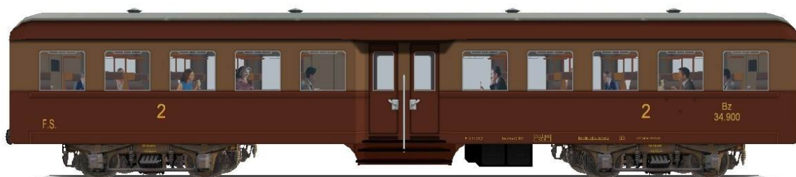
Illustrazione 8: Tipo 1947, Bz 34.900 (1958-70) consegnate nel 1958 e dotate di quattro aeratori sul tetto
