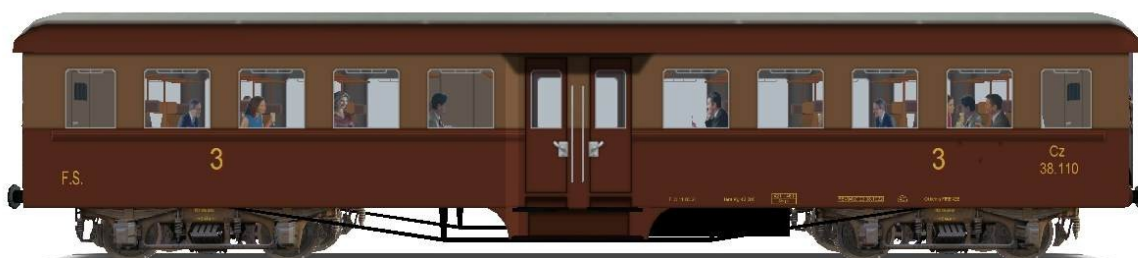
Illustrazione 4: Tipo 1951, Cz 38.110 (1951-56) vetture costruite su telai corti tipo 1906, nel pack vi sono due versioni di queste vetture: la versione in figura e una vettura di testa (vedi paragrafo Luci, testa e coda ).
