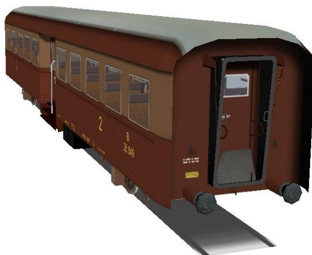
Illustrazione 26: Carrozza di coda, ha l'intercomunicante chiuso per poter agganciare posteriormente un veicolo privo di intercomunicante
