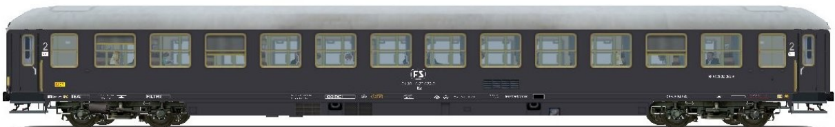
Illustrazione 14: Carrozza di seconda classe, Bz 51 83 10-70 072-0 con porte in acciaio, ambientabile tra il 1972 e il 1980.
