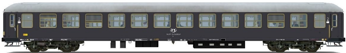
Illustrazione 4: Carrozza di seconda classe, Bz 51 83 22-71 993-2 con porte in acciaio, ambientabile tra il 1966 e il 1980.
