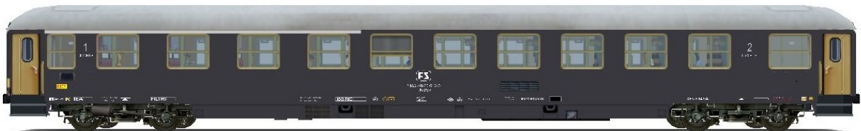
Illustrazione 13: Carrozza mista di prima e seconda classe con cuccette, AcBcz 51 83 40-70 012-0 con porte in alluminio, ambientabile tra il 1980 e il 1990.
