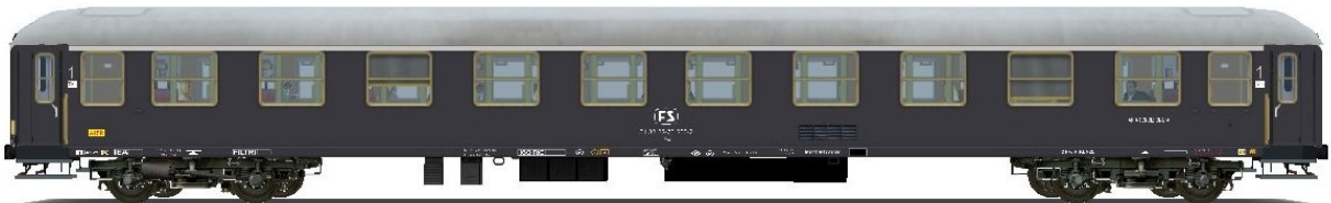
Illustrazione 9: Carrozza di prima classe, Az 51 83 22-70 253-2 con porte in acciaio, ambientabile tra il 1967 e il 1980.
