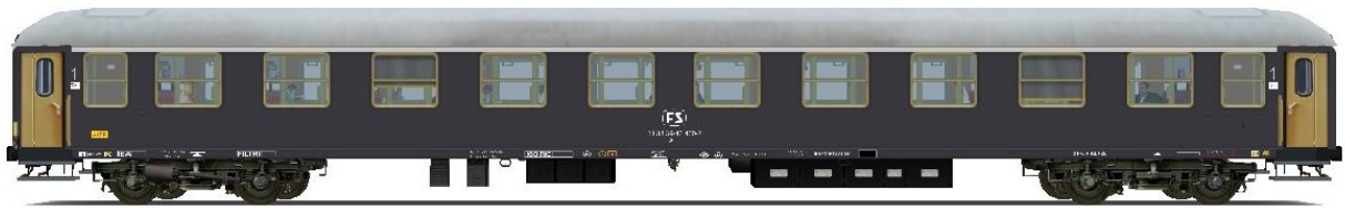
Illustrazione 2: Carrozza di prima classe, Az 51 83 39-40 400-7 con porte in alluminio ambientabile, tra il 1980 e il 1995.
