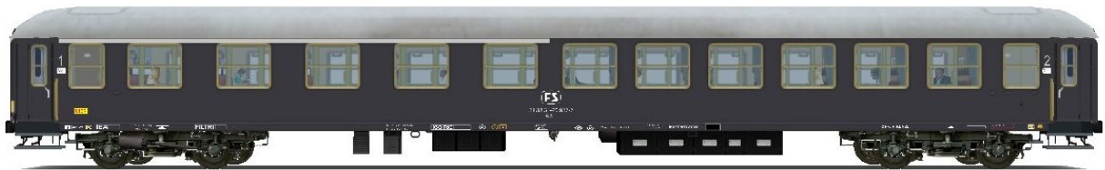
Illustrazione 3: Carrozza mista di prima e seconda classe, ABz 51 83 31-70 957-7 con porte in acciaio, ambientabile tra il 1966 e il 1980.
