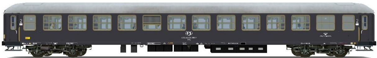
Illustrazione 6: Carrozza di seconda classe con posto di ristoro piccolo, BRz 50 83 85-88 206-5 con porte in acciaio, ambientabile tra il 1966 e il 1990.
