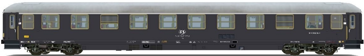
Illustrazione 12: Carrozza di prima classe, Az 51 83 22-70 253-2 con porte in acciaio, ambientabile tra il 1972 e il 1980.
