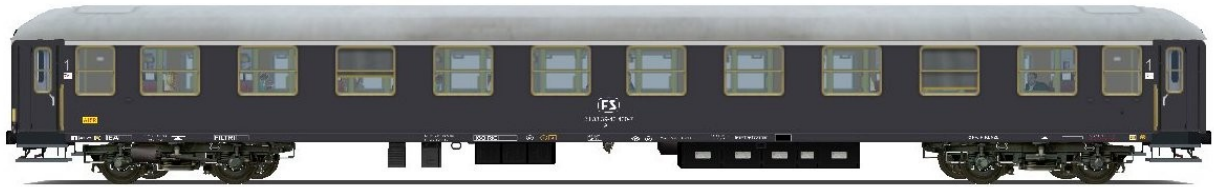
Illustrazione 1: Carrozza di prima classe, Az 51 83 39-40 400-7 con porte in acciaio ambientabile, tra il 1966 e il 1980.
