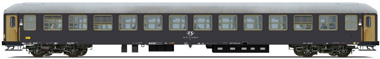
Illustrazione 5: Carrozza di seconda classe, Bz 51 83 22-71 993-2 con porte in alluminio, ambientabile tra il 1980 e il 1995.
