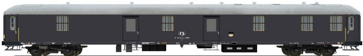
Illustrazione 8: Carrozza postale, UIz 51 83 90-70 016-0 con porte in acciaio, ambientabile tra il 1966 e il 1990.
