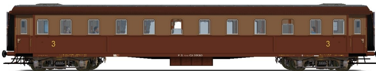
Illustrazione 12: Vettura di terza classe Cz 30.000-552, 560-709 come appariva tra il 1946 e il 1958 con numeri indicante la classe in cifre arabe 1, 2, 3.
