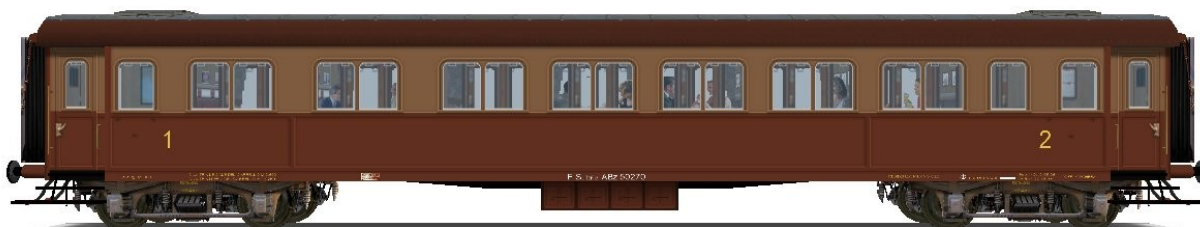
Illustrazione 4: Vettura mista di prima e seconda classe ABz 50.100-716 come appariva tra il 1946 e il 1958 con numeri indicanti la classe in cifre arabe 1, 2, 3.
