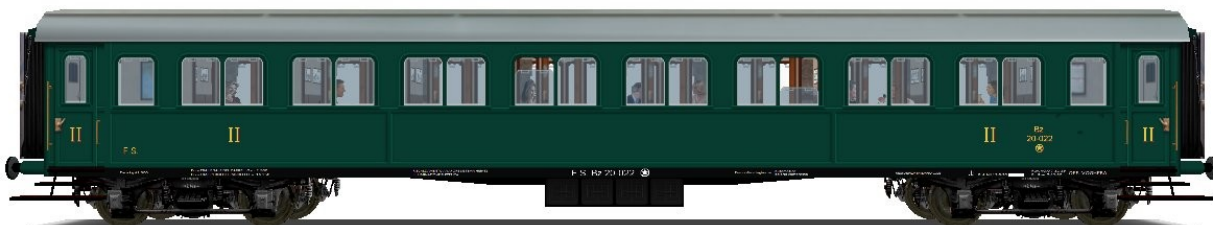
Illustrazione 17: Vetture di seconda classe Bz 20.000-270 come appariva tra il 1924 e il 1936.
