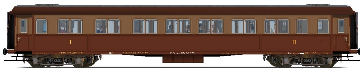
Illustrazione 1: Vettura mista di prima e seconda classe ABz 50.100-716 rimodernata con il tetto in lamiera e la colorazione castano e isabella che hanno adottato nel 1936.
