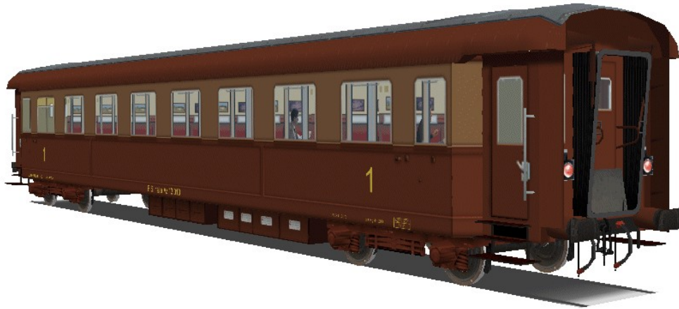
Illustrazione 5: vettura Az 13.010 di prima classe con luci di coda.
