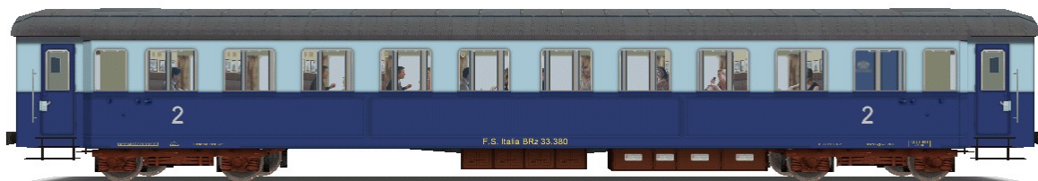
Illustrazione 12: vettura Bz 33.010 di seconda classe con compartimento ristoro per Trenos Azzurro (1956-1966)
