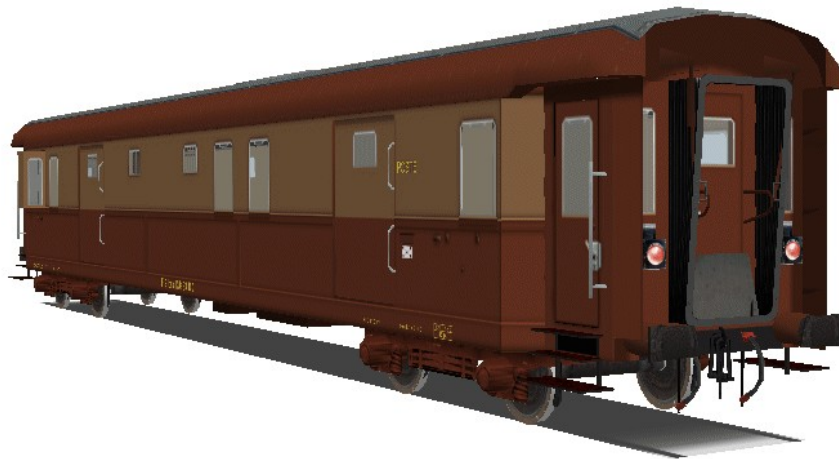
Illustrazione 6: bagagliaio posta DUz 93.100 con luci di coda in uso fino al 1964. Questi bagagliai continuarono a viaggiare nella livrea castano e isabella fino agli anni '70.
