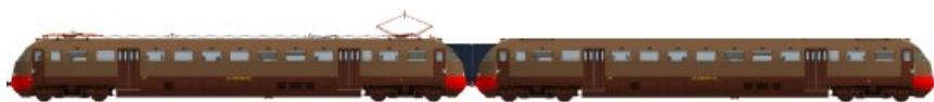
Illustrazione 8: Treno Genova - Albenga composto da una ALe 840 e una rimorchiata Le 840.
