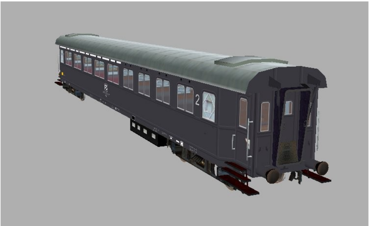
Figura 2 carrozza di prima e seconda classe serie Abz 61.000 con soffietto chiuso da mettere in testa al treno (dietro la locomotiva o dietro a veicoli non dotati di soffietto di intercomunicazione)
