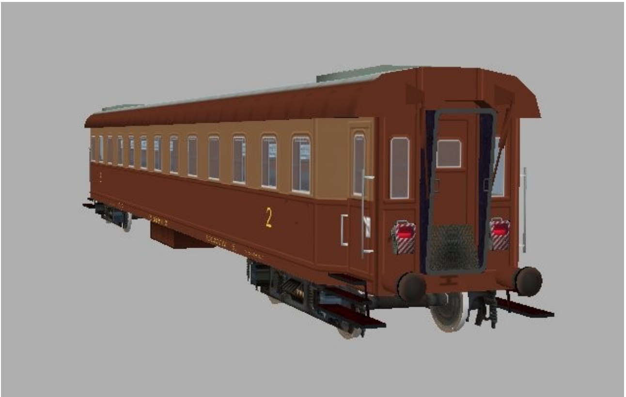
Figura 3 carrozza di seconda classe serie Bz 31.000 dotata di luci di coda convoglio
