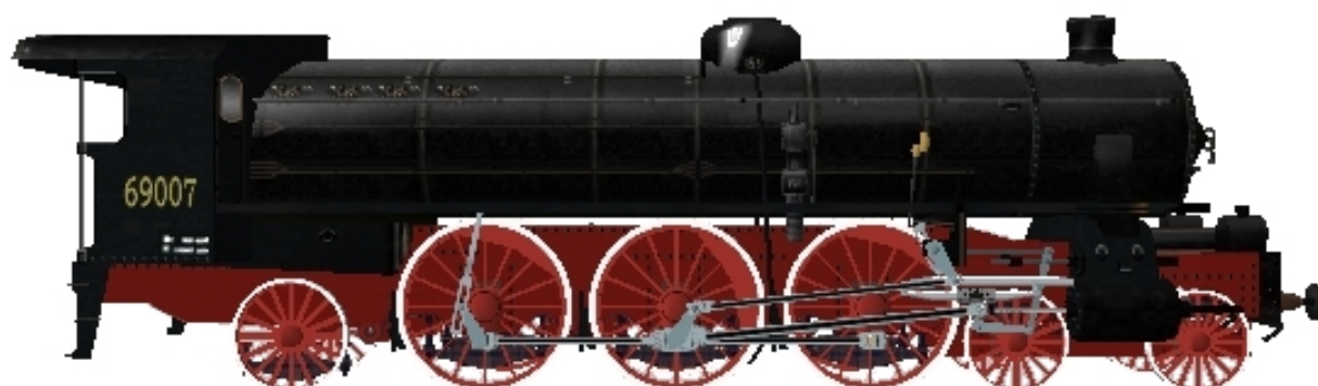
Figura 3 Locomotiva a vapore Gr. 690 con rodiggio 2-3-1 tipo Pacific per treni espressi.
