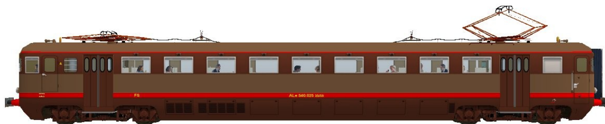
Illustrazione 4: ALe 540 di terza serie (1959-90) con lo stesso allestimento interno della seconda serie ma con le estremità della cassa di nuovo disegno.
