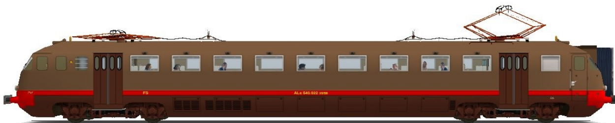
Illustrazione 3: ALe 540 di seconda serie stato dopo le modifiche effettuate negli anni '60 (1958-90). Rispetto alla prima serie era stato spostato il bagno ad una estremità e il salone centrale era ad ambiente unico.
