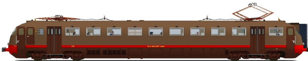
Illustrazione 2: ALe 540 di prima serie stato di origine (1957-70). All'esterno erano praticamente identiche alle ALe 660, cambiava unicamente l'allestimento interno.
