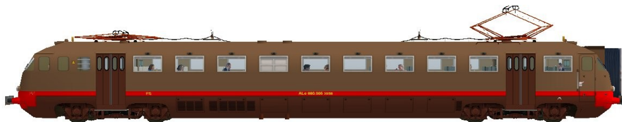
Illustrazione 1: ALe 660 di prima serie con le modifiche effettuate nel corso degli anni '60(1955-90).
