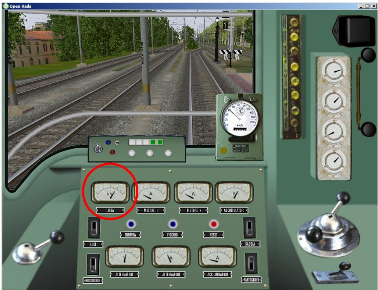
Illustrazione 5: Se l'ago dell'indicatore nel cerchio rosso è tutto a sinistra il motore non è alimentato, premere il tasto "P" e il motore sarà alimentato e l'ago andrà nella posizione in figura
