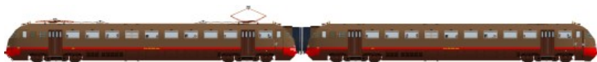
Illustrazione 8: Treno Milano - Lugano composta dalla ALe 540.009 e dalla Le 540.004. A chiasso venivano agganciate ad una locomotiva Svizzera FFS Ae6/6 per proseguire fino a Lugano. Anni '70-'80.
