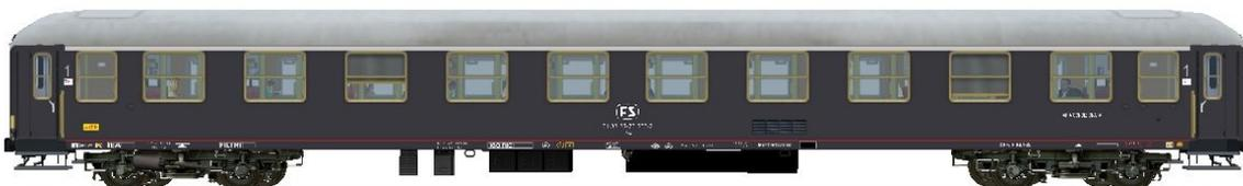
Anche alcune carrozze ristorante ex CIWL tipo 1925R dotate di carrelli Minden-Deutz furono autorizzate a 180 km/h e distinte dal filetto rosso, per essere inserite nei treni impostati ad oltre 160 km/h nelle linee succitate.
