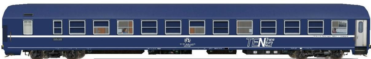
Vettura MUfd TEN delle FS, con carrelli tipo MD.
