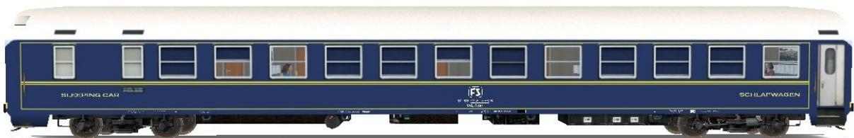
Vettura M TEN delle FS, con carrelli tipo L e carenatura sottocassa.
